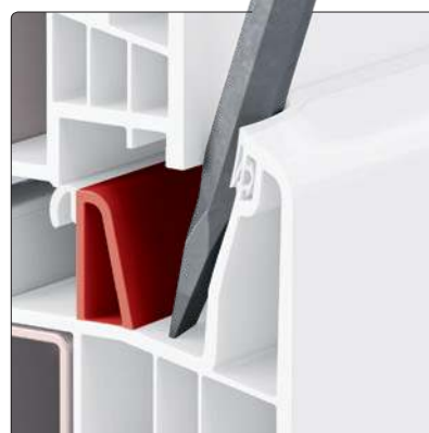
Doppelwandiger Mittelsteg erschwert das Einstechen mit einem spitzen Werkzeug.
