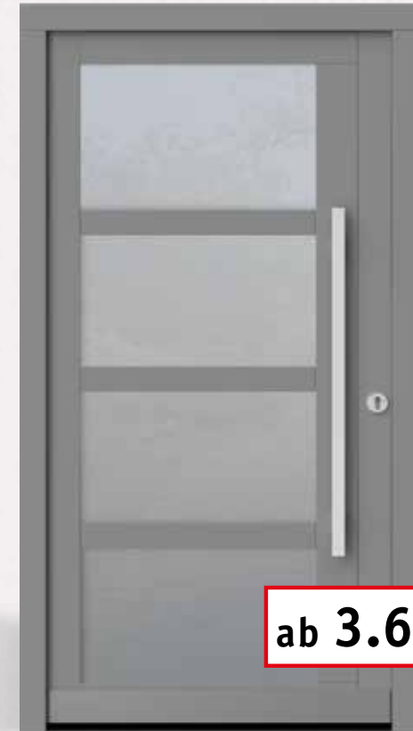
AH 94439 | Rahmenkonstruktion | Edelstahl-Flachstangengriff 1000 mm mit geraden Stützen | Rundrosette | Betongrau RAL 7023 | Profilierung Lichtfase | Aufbauprofil 115 mm senkrecht schlossseitig | waagerechte glasteilende Sprossen 78 mm breit | mit Holzwetterschenkel
