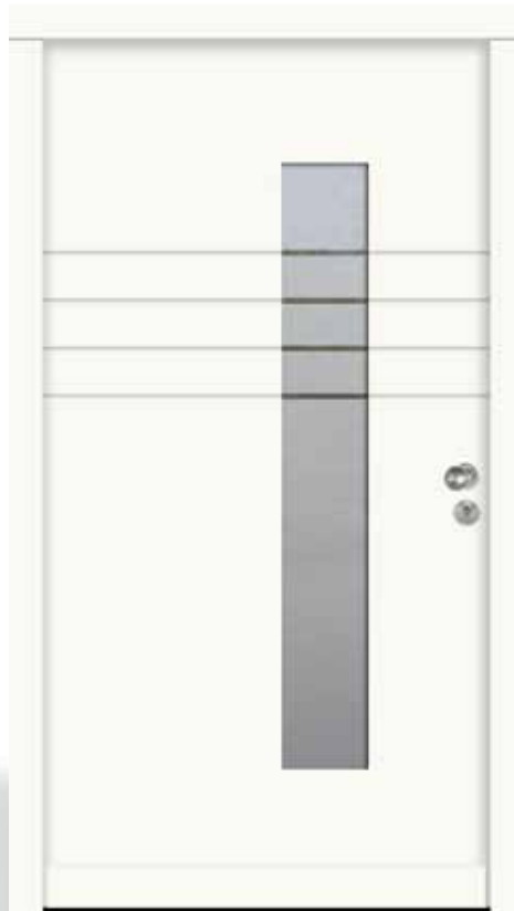
AH 01123 | Edelstahl-Knauf | Rundrosette | Verkehrsweiß RAL 9016 | matt | Lichtausschnitt 200 x 1400 mm | Dekorglas ADG1, Sandstrahlung mit Klarglasstreifen | Nuten außen
